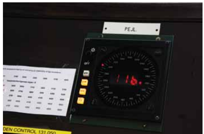
Pejlutrustningen kan vara en räddare i nöden för den vilsna piloten. Kom ihåg att även AFIS kan hjälpa till med pejl.
