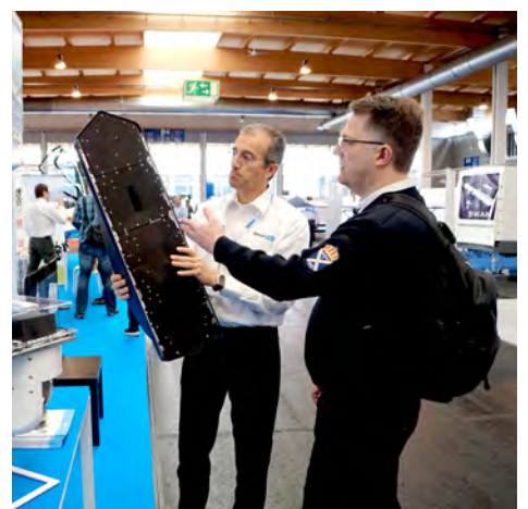
En kamerapod för montering under vingen. Kamerorna tar cirka tio minuter att montera bort och planet kan sedan användas i klubben igen.
