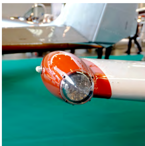
Flera flygplan lanserades med LED-lampor. Möjligheten fanns också för att byta ut på befintliga flygplan, exempelvis PA28.
