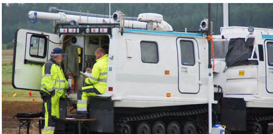
I det mobila lednings och sambandsfordonet (MOLOS) finns gott om utrustning att både prata med flygbesättningarna. I och med att sambandet sker med både flygradio och med RAKEL krävs flera mottagningsenheter.
